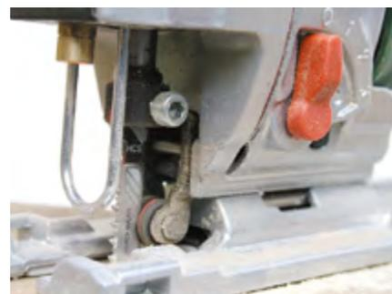
▲ Рычаг четырехступенчатой регулировки маятникового хода с большим, легко переключаемым шагом.
