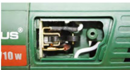
▲ Сразу бросаются в глаза съемные крышки щеточного узла, упрощающие доступ для контроля над состоянием угольных щеток или их замены, при необходимости.
