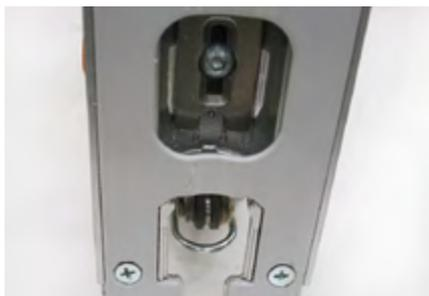
▲ Для наклонных резов подошва может быть зафиксирована под углом до 45° в обе стороны (по три фиксированных положения).
