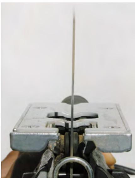
▲ «Ощупывание» опорного ролика сразу же выявило небольшой поперечный люфт. И не самого ролика, а «лапы», на которую он посажен. Однако проверка стабильности холостого хода пилки на максимальной скорости показала идеальный результат.
