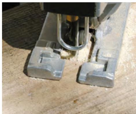
Предусмотрена производителем и система обдува рабочей зоны, обеспечивающая хорошую видимость разметки при распиловке материалов.
